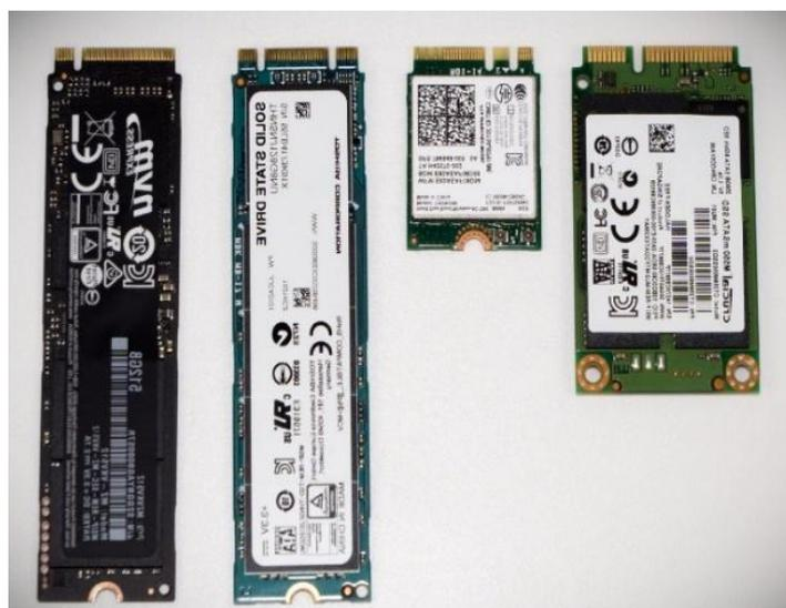
*Рисунок 5 – твердотельный накопитель «SSD M2»*
