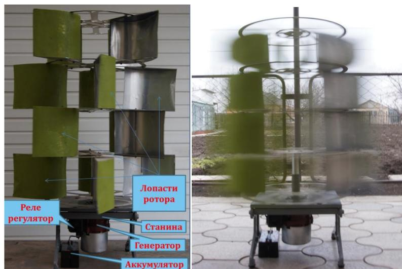
*Рисунок 3 – Модель ветрогенератора и его работа*
