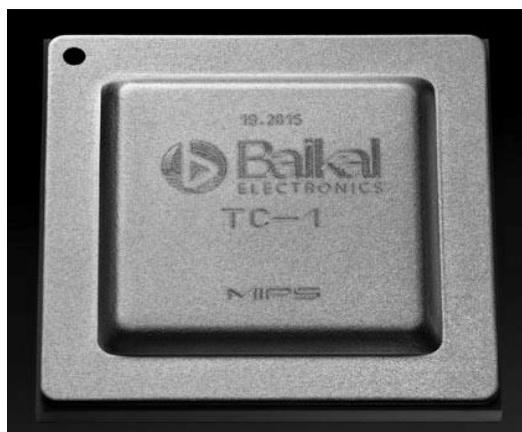
*Рисунок 2 - процессор «Baikal TC-1»*
