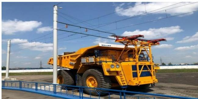
Рисунок 5: Большегрузный самосвал БЕЛАЗ-7530Е – дизель-троллейвоз
